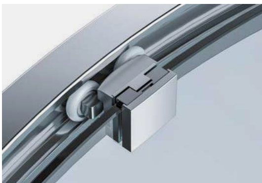
↑ Подвійний роликівим механізм сприяє зниженню вібрації та шуму. Двері рухаються плавно і тихо.
