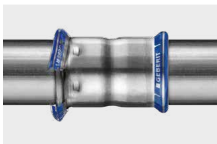
Кольорові індикатори прес-з'єднання Mapress вказують на неопресовані з'єднання ще до початку випробувань
