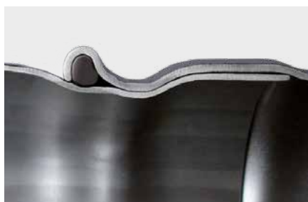
Прес-з'єднання забезпечує механічну міцність та гідравлічну герметичність
