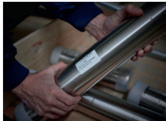
Простий монтаж завдяки послідовному та чіткому маркуванню секцій труб за довжиною.
