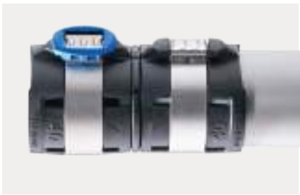
Легко ідентифікувати навіть у темних кутках: або індикатор пресування все ще на фітингу, або з'єднання вже було спресоване.
