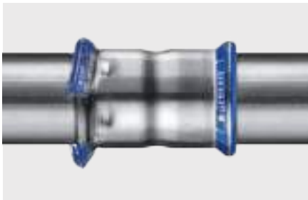
Кольорові індикатори прес-з'єднання Mapress вказують на неопресовані з'єднання ще до початку випробувань
